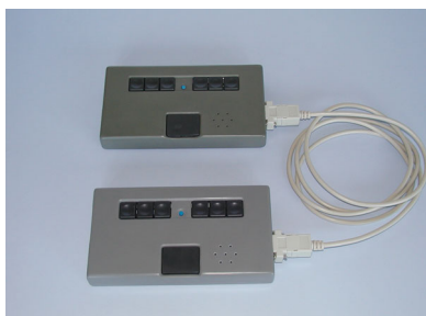
Komunikace přes sériovou linku po kabelu
